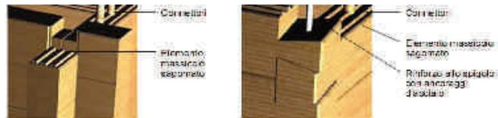
Figura 3: Altri tipi di collegamenti allo spigolo per il sistema costruttivo massiccio
